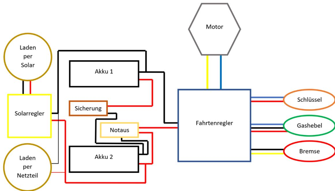
Schließt die Batterien zuletzt an, um sicher zu gehen das keine Teile Schaden nehmen.
